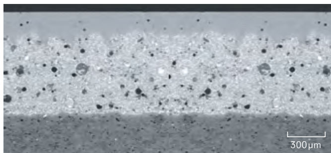
Micrographie WC CEFIONTECT * 1 µm=0,001 mm
